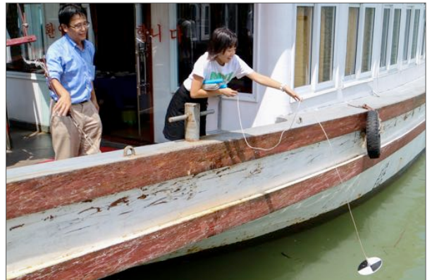
ハロン湾で JICA 専門家の指導を受けながら、海水の透明度を測る透明度板を実際に使ってみる。「海水は緑色で、水深 2m で見えなくなっていました」(14HR・福岡良美)
