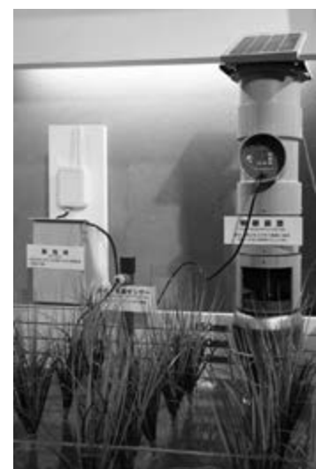
【水位自動調節システム】
